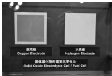
水素電力貯蔵システムに用いられる 固体酸化物型電気化学セル(東芝)
