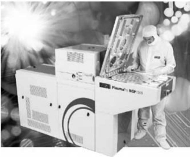
Oxford Instruments 450mmウェーハのエッチツール SEMICON Europaでのプレゼンテーション資料: EEMI450プロジェクト Richard Oechsner氏
